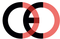
Falsche CE-Kennzeichnung (zu dicht)
