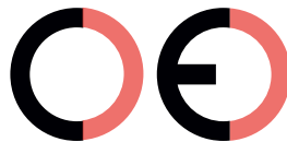
Falsche CE-Kennzeichnung (zu großer Zwischenraum)
